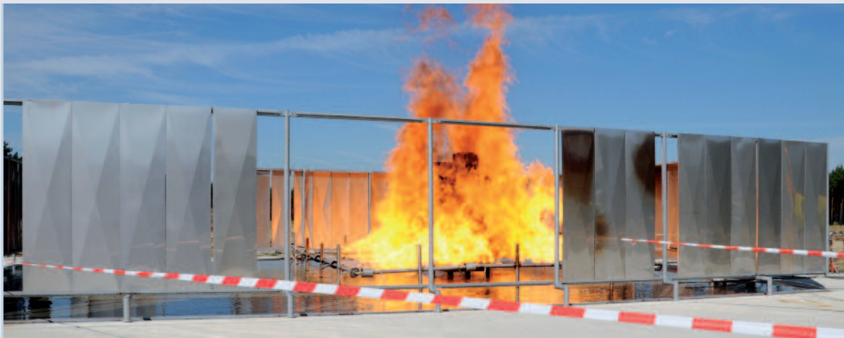
Brandprüfstand für zerstörende Versuche zur Prüfung der thermischen Belastbarkeit von Behältern
